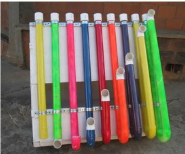
Esta vez amarramos los tubos a la estructura de madera con argollas metálicas de las que se usan justamente para sostener tubos.
